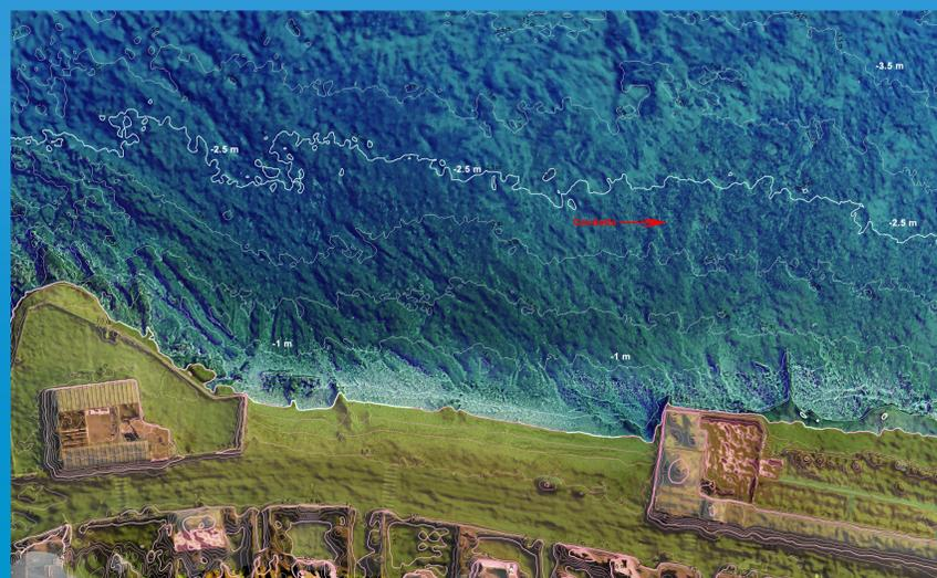
DEM topo-batimetrico con curve di livello ottenuto da rilievo drone
